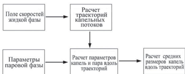
Рис. 2. Структурная схема бесконтактного метода определения средних размеров капель
