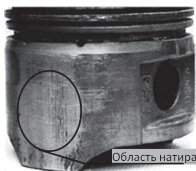
Рис. 1. Результат контактного взаимодействия поршня и гильзы цилиндра дизеля
