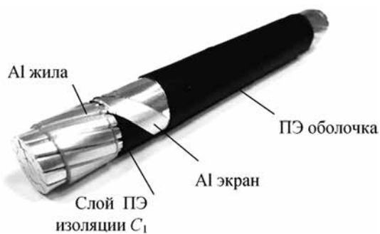
Рис. 8. Макетный образец цилиндрического конденсатора
