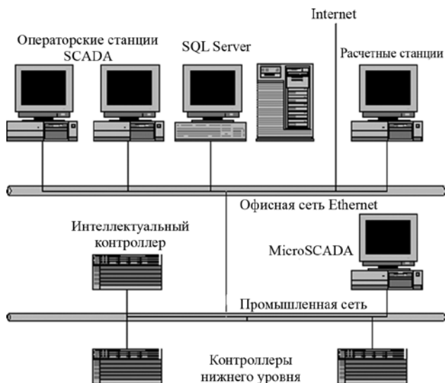
Рис. 1. Обобщенная схема АСУ ТП на основе SCADA-систем
