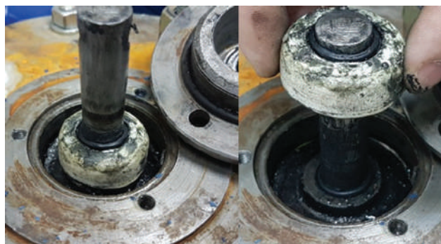
Рис. 3. Герметичное уплотнение вала модельного полирядного насоса
