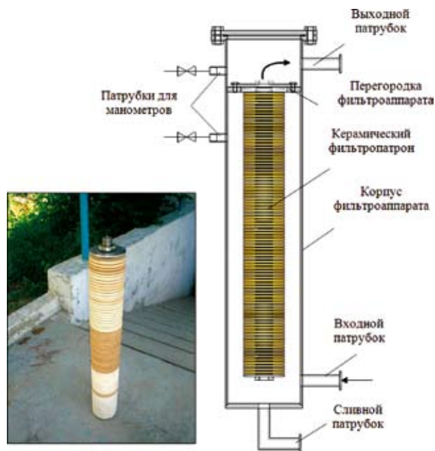
Рис. 2. Конструкция керамического фильтра для очистки трансформаторного масла
