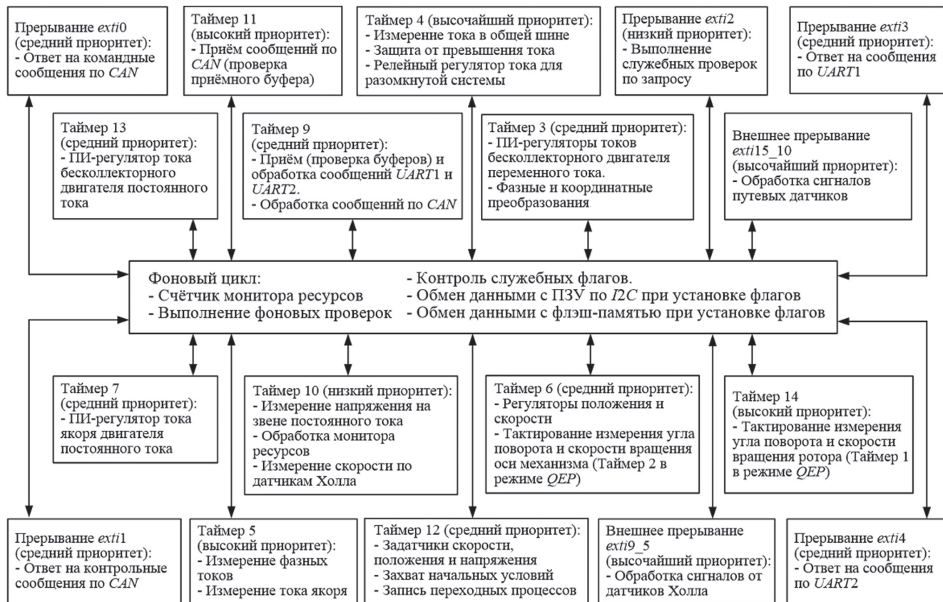
Рис. 2. Схема исполняемой модели системы управления электропривода
