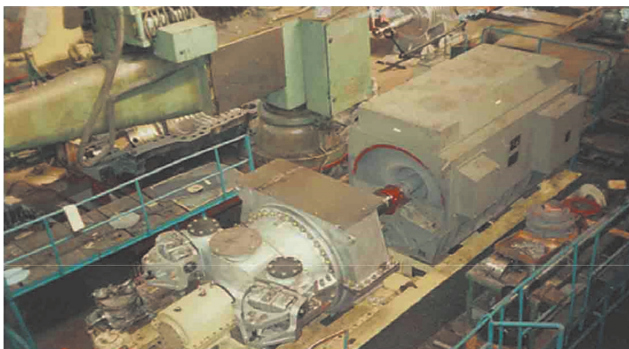
Рис. 7. Турбогенератор мощностью 2,5 МВт для ГеоЭС San Jacinto на заводском стенде АО «КТЗ»
