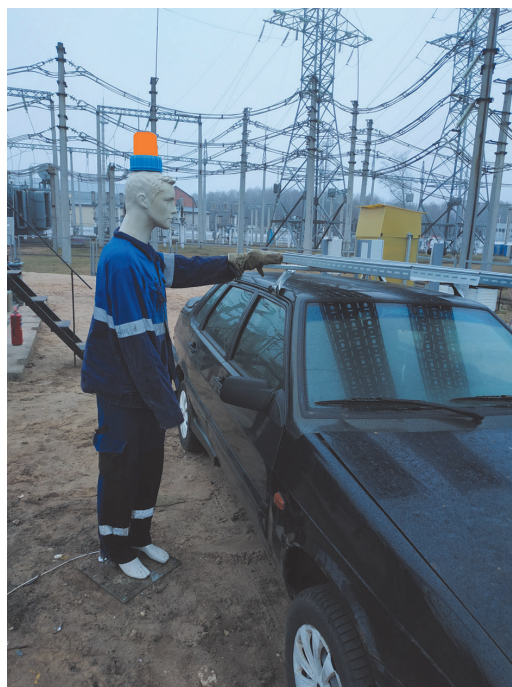
Рис. 5. Испытание стенда «Падение провода ВЛ 10 кВ на автомобиль» с фиксацией срабатывания световой и звуковой сигнализаций при превышении допустимого значения напряжения прикосновения
