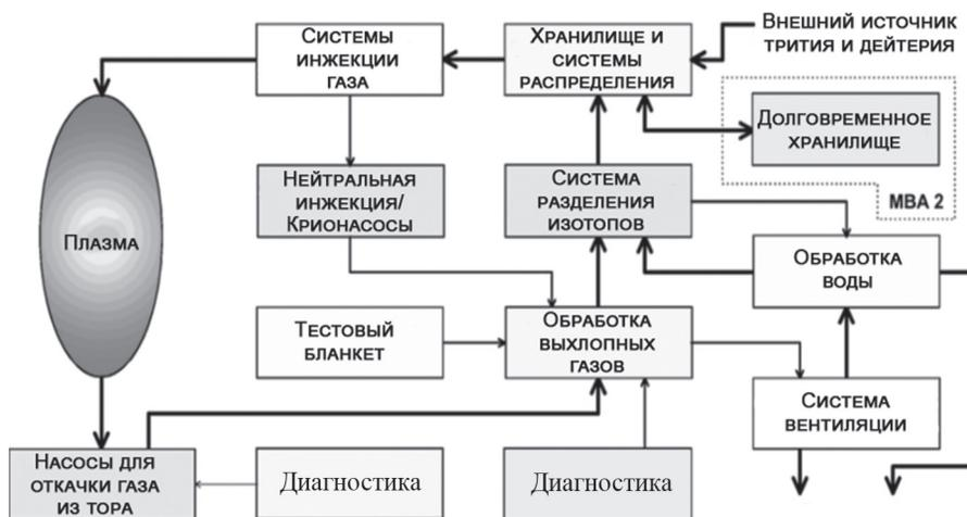
Рис. 5. Структурная схема ТЦ ИТЭР с основными системами ТЦ и условными коммуникациями между ними
