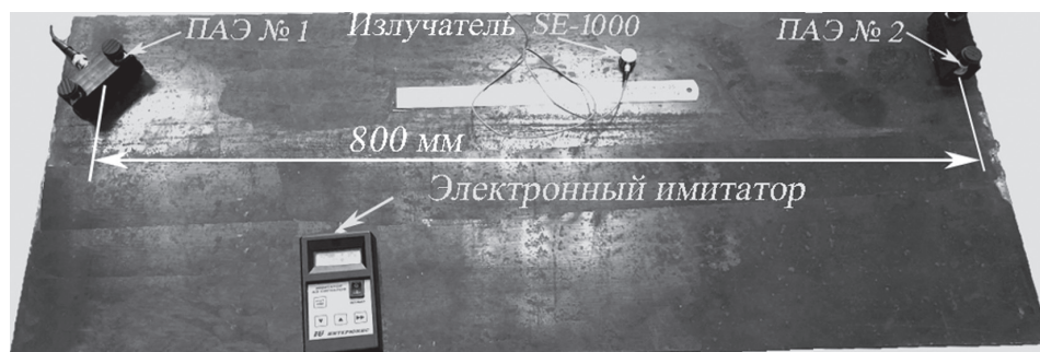
Рис. 1. Схема построения линейной локации источников АЭ
