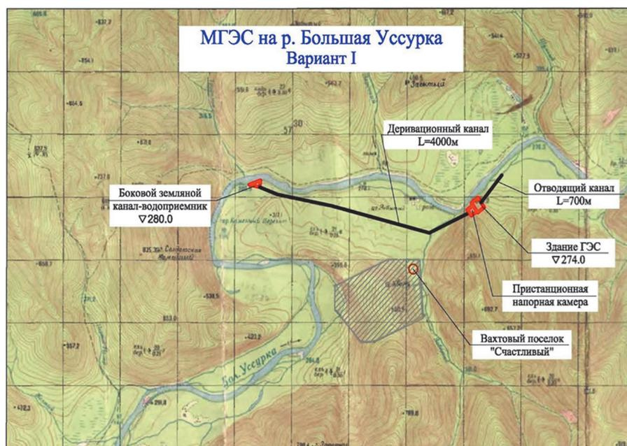
Рис. 7. Схема размещения объектов МГЭС на местности (вариант 1)
