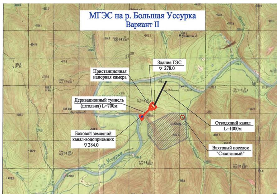
Рис. 8. Схема размещения объектов МГЭС на местности (вариант 2)
