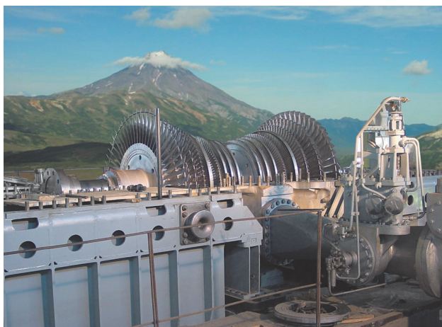
Рис. 7. Двухпоточная паровая турбина мощностью 25 МВт для Мутновской ГеоЭС
