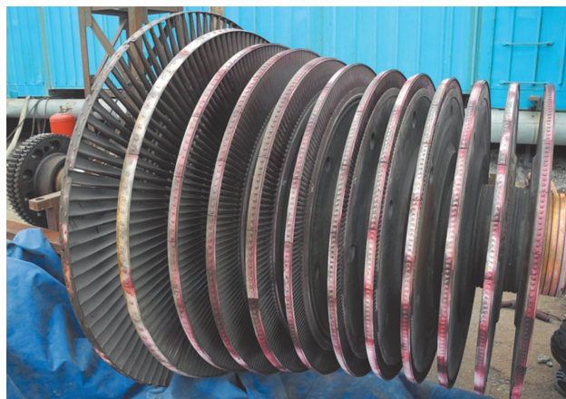
Рис. 4. Ротор турбины «Туман-4К» Верхне-Мутновской ГеоЭС
